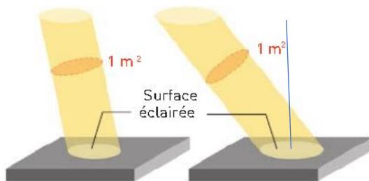
Comment évolue la surface éclairée par un faisceau lumineux en fonction de l'angle d'inclinaison ? Pour répondre à cette question, on réalise une expérience : un faisceau lumineux avec une section de  $1 \text{ m}^2$  est dirigé vers un plan. On fait varier l'inclinaison du faisceau et on mesure l'aire de la surface éclairée en fonction de l'angle formé avec la perpendiculaire.
