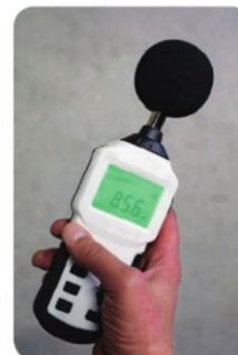
Le niveau sonore se mesure à l'aide d'un sonomètre. L'appareil mesure la pression acoustique et affiche le niveau sonore en décibels à l'écran.
